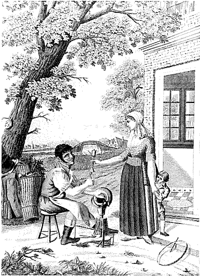
Rondtrekkende ketellapper, eerste helft 19e eeuw. Terwijl hij met één voet de blaasbalg bedient, bewerkt hij op het aambeeld een ketel. Links van hem staat zijn mars met allerhande koperwaren. (Atlas van Stolk, Rotterdam, 5660 III).
