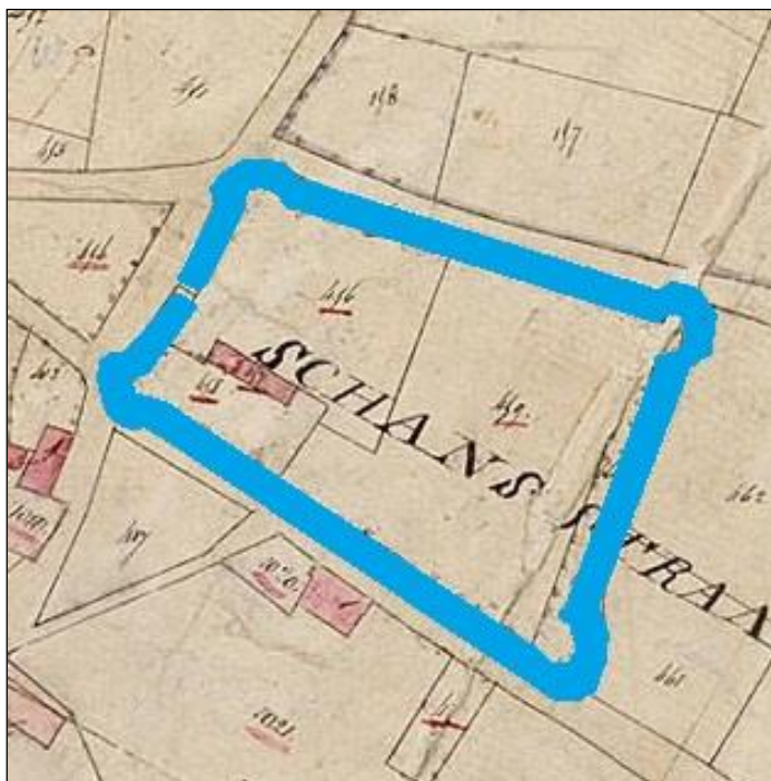
Figuur 13. De Kreijelerschans op de kadastrale minuutkaart van 1844. Het terrein meet ongeveer 100x 80 m. Op de hoek zijn de bastions zichtbaar. De gracht staat op het origineel getekend en is voor deze publicatie blauw ingekleurd. Foto: RHCE/tek. Alfons Bruekers.
